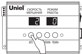
Рисунок 5. Пример изменения режима работы контроллера
