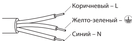
Рисунок 1. Схема подключения прожектора
