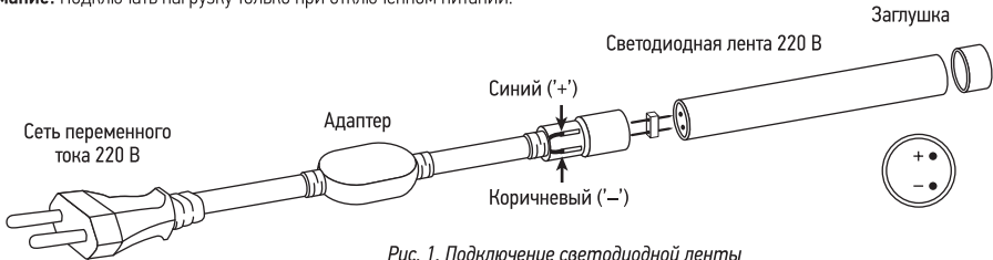
Рис. 1. Подключение светодиодной ленты
