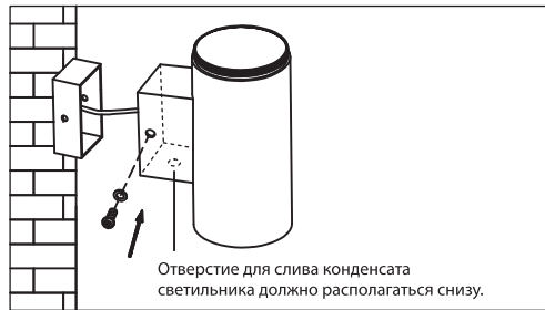
Рисунок 4. Установите светильник на место и зафиксируйте с помощью 2 крепежных болтов или саморезов.
