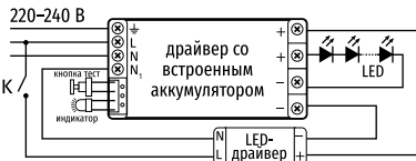
Схема подключения БАП в светильнике ДВО-07-А
