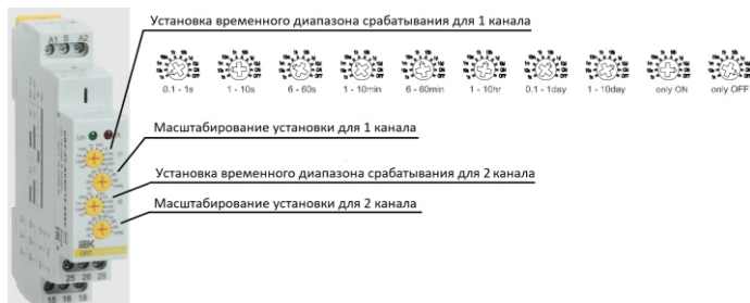
Рисунок 5 – Назначение органов управления реле
