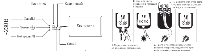
Рис.1. Схема подключения светильника SPO-7-50/ SPO-7-72 к сети 230В.
