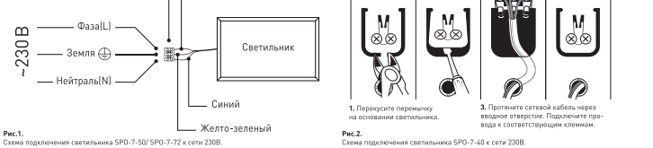
Рис.1. Схема подключения светильника SPO-7-50/ SPO-7-72 к сети 230В.
