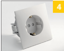
4 корпус из поликарбоната (не поддерживает горение, температура воспламенения свыше 850 градусов C)
