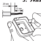
Рисунок 3. Зачистить кабель согласно рисунку. Пропылить в крышке отверстие для ввода кабеля согласно его диаметру.
