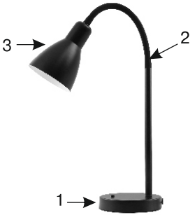
Рис.1, конструкция: 1. Основание 2. Стойка 3. Плафон
