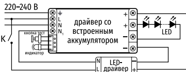
Схема подключения БАП в светильнике ДВО-07-А
